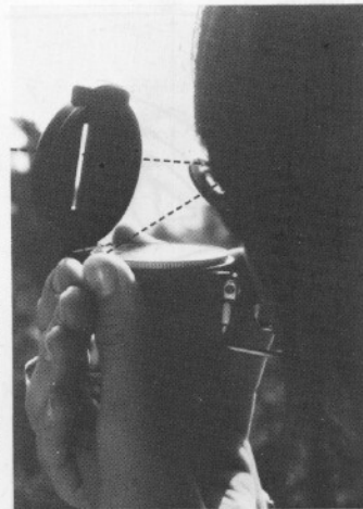
Fig. 42 Utilisation d'un compas de relèvement: on vise l'objet et à l'aide de la loupe on lit le relèvement sur la rose graduée.
