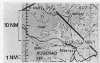
Fig. 53 Une minute d'arc sur un méridien quelconque correspond à un mille nautique (1,852 km).
