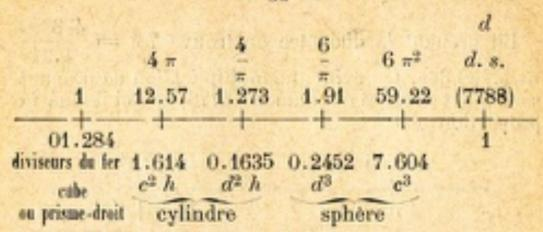
Exemple: Quel est le poids d'une barre de fer de la forme d'un prisme droit à base rectangle dont les dimensions sont: largeur 0.75, épaisseur 0.30, longueur 5 mètres. Le poids est donné par la formule
