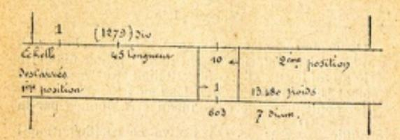
On amène le nombre 45 de l'échelle des carrés sous le 1,279 de la règle. Comme le 7 de la Règle ne rencontre plus la réglette, on retire la réglette à droite et l'on place l'indicateur 1 des carrés à l'endroit que désignait l'indicateur 10 dans la première position.
