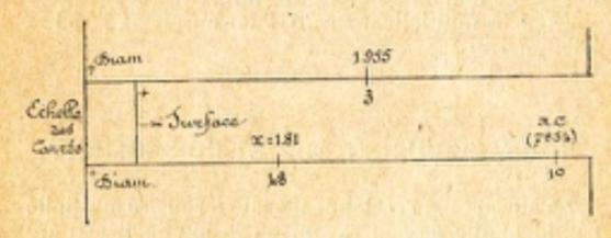
Quel est le diamètre du cercle qui a pour surface 3=? Au-dessus du 3 pris sur la réglette on lit pour diamètre 1,955.
